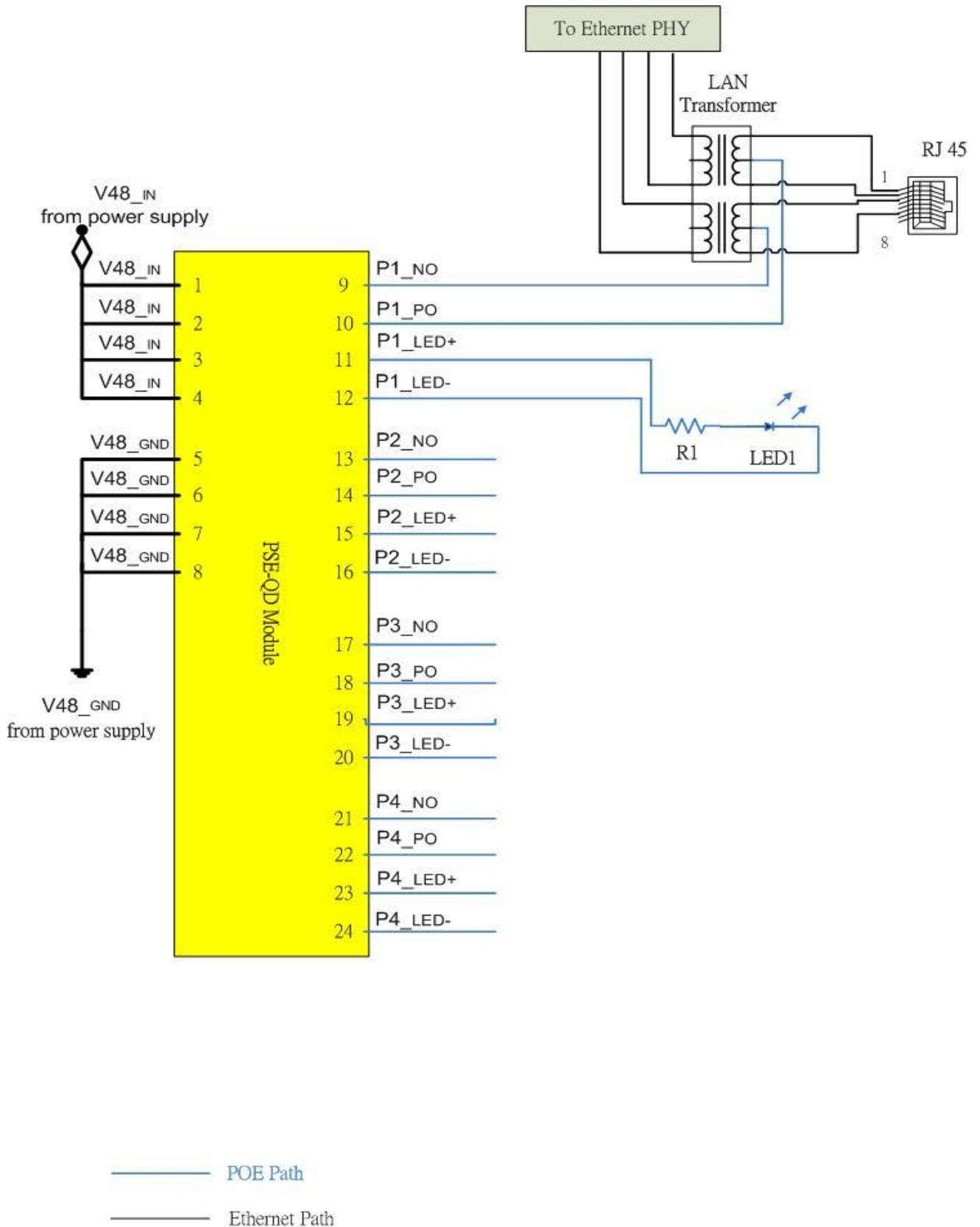
**C. 雙倍功率模式 (同時連接 2 個 PD 在遠端以獲得雙倍功率) (以一通道為例)**
